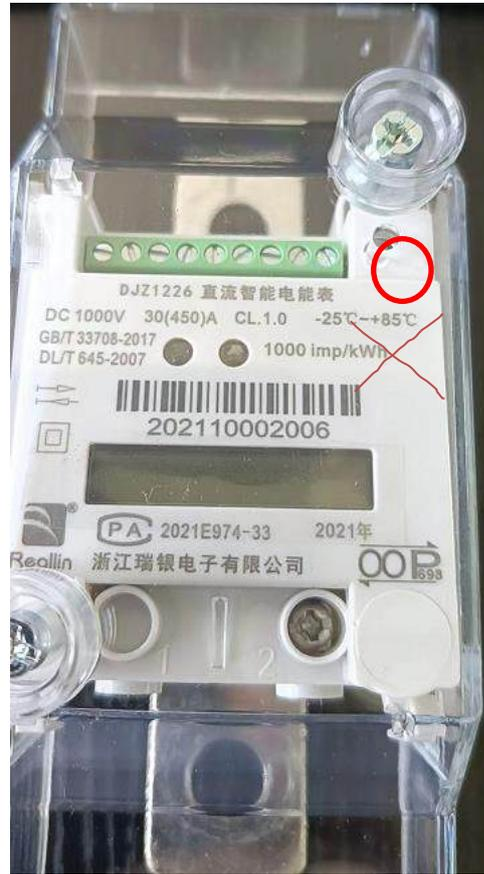
当接线端子上接的线比较多时，务必将导线卡入表盖上的导线槽内，且透明罩壳上的破拆口需要破拆用于走线
